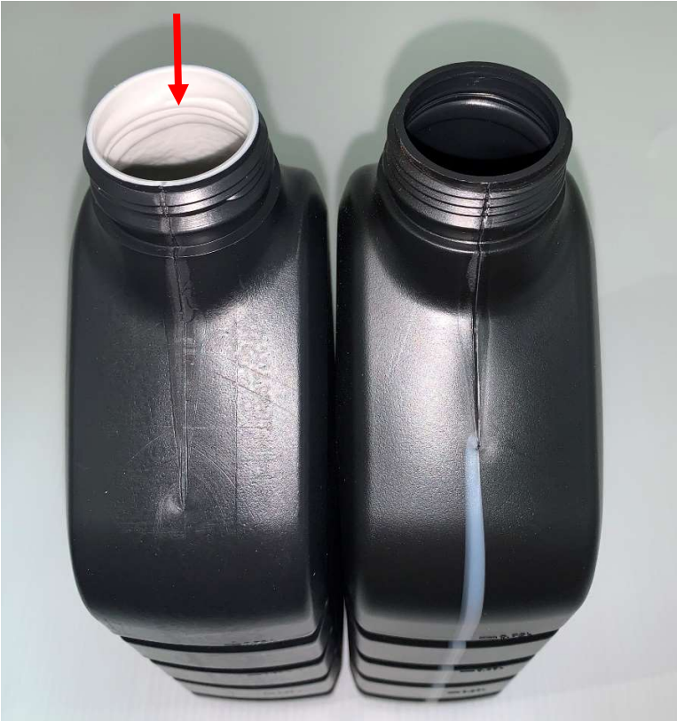
Figura 3. Frascos de 1 L (BrasAlpha) apresentando da esquerda para a direita: material exemplificativo das camadas internas contendo resina reciclada (PCR); material comercializado. (Fonte: Elaborado pelos autores, 2024.)
