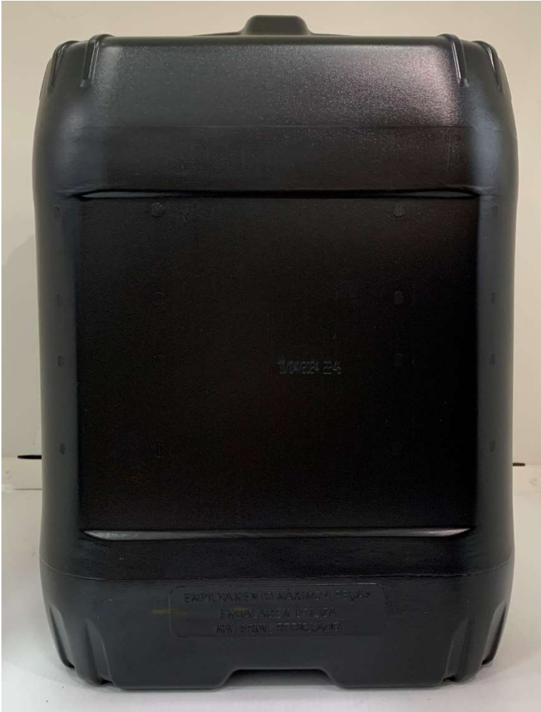
Figura 5. Embalagem de 20 L (Raízes) produzida com 40% de resina reciclada (PCR). (Fonte: Elaborado pelos autores, 2024.)
