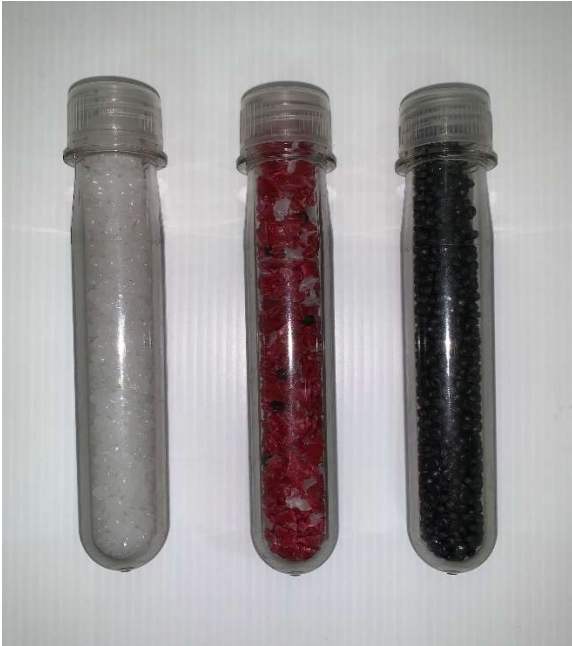
Figura 2. Da esquerda para a direita: pellet produzido com material virgem, material pós-consumo pré-processado; pellet de resina reciclada (PCR) pigmentada. (Fonte: Elaborado pelos autores, 2024.)
