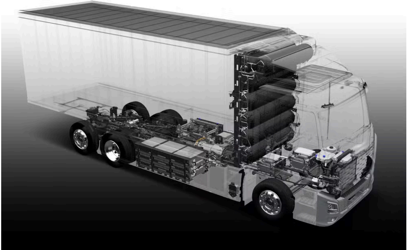
Hyundai Xcient fuel cell FCEV caminhão célula de combustível a hidrogênio — Foto: autoesporte
