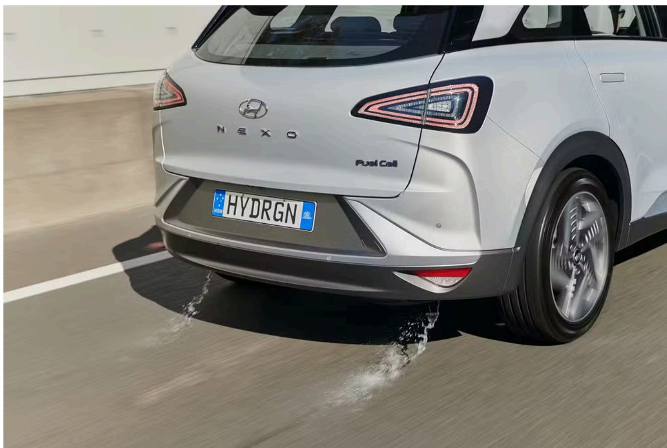
Hyundai Nexo FCEV saída de escape com água — Foto: autoesporte
