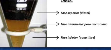
Diariamente los tanques de combustible acumulan agua por procesos de condensación (variación de temperatura ambiente). El combustible absorbe agua (poder higroscópico) y su presencia debe ser evitada lo máximo posible (drenado periódico), realizándose verificaciones constantes.
