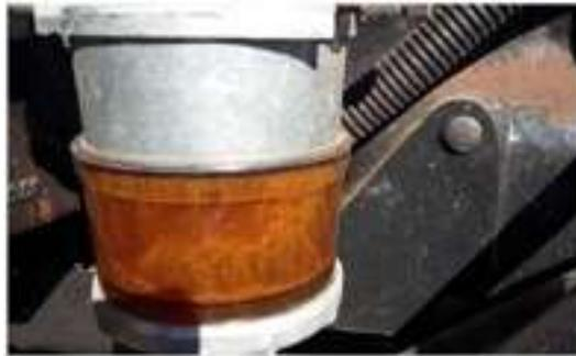
**Figura 11.** Filtro separador saturado com água e sedimentos.
