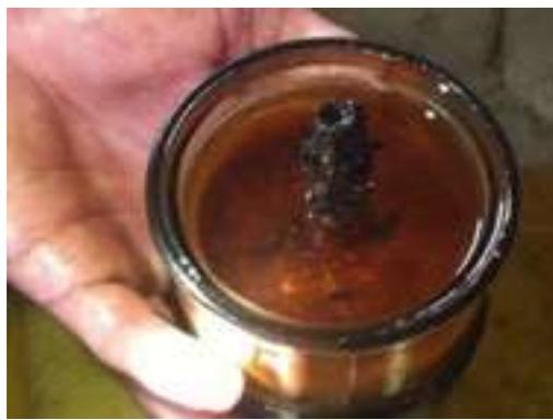
**Figura 12.** Filtro separador de trator com água e sedimento de origem microbiana.
