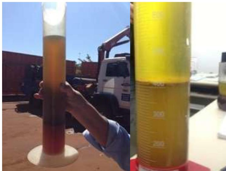
**Figura 16.** Aspecto de óleo diesel extraído de filtro de caminhão em setor sucroalcooleiro, presença de água livre e biomassa na interface óleo-água.
