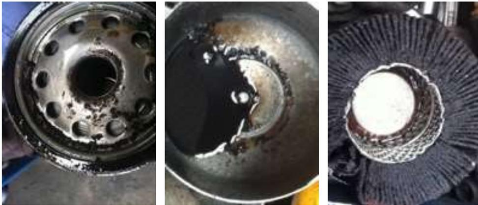
**Figura 14.** Filtro de ônibus saturado - Oxidação e Sedimentos.
