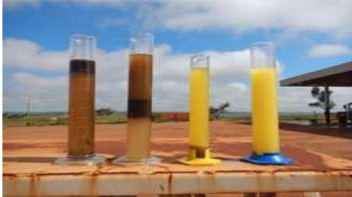
**Figura 20.** Aspecto de amostras óleo diesel coletadas em tanques que não são drenados corretamente.
