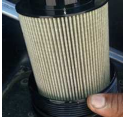
Imagem 4. Elemento filtrante analisado após rodagem com diesel S10 B10 com estabilidade oxidativa média de 46 horas. Separação de água com média de 90%. Fonte Volkswagen Caminhões e Ônibus.
