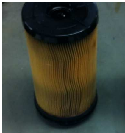
Imagem 7. Elemento filtrante analisado após rodagem com diesel S10 B15 com estabilidade oxidativa média de 27 horas. Separação de água com média de 95,5%. Fonte Volkswagen Caminhões e Ônibus.
