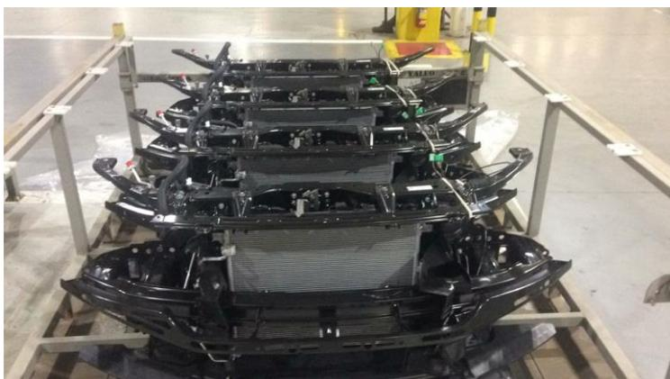
Figura 13 – Nova disposição dos módulos frontais
