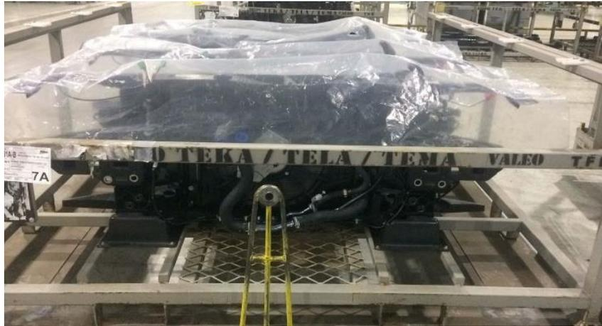
Figura 11 – Rack especial com o módulo frontal do Civic com a capa plástica
